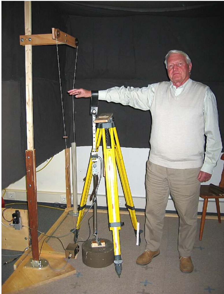
Bild 3 Die Anordnung in der Meßkabine mit der Testperson, der Zugerzeugung mit dem Druckzylinder, dem Kraftmesssensor und der Messvorrichtung für die Handlage
